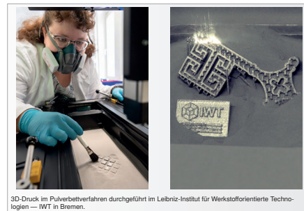
3D-Druck im Pulverbettverfahren durchgeführt im Leibniz-Institut für Werkstofforientierte Technologien — IWT in Bremen.
