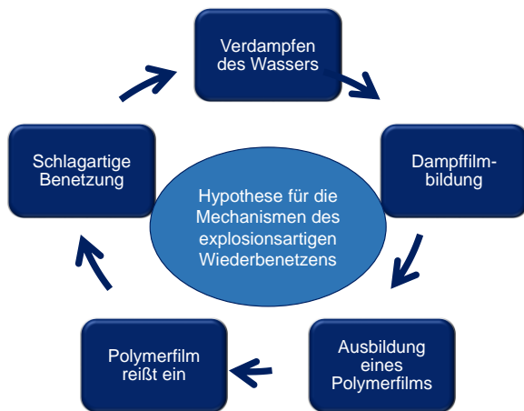
Bild 1: Hypothese für die Mechanismen des explosionsartigen Wiederbenetzens
